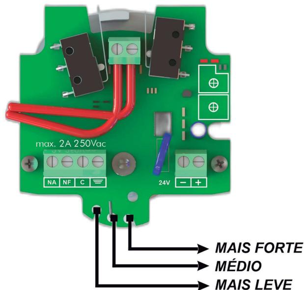
■ ESQUEMA DE INSTALAÇÃO
